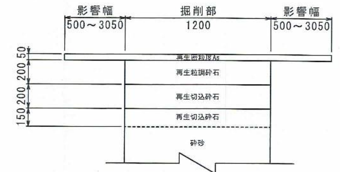
埋戻断面標準図
